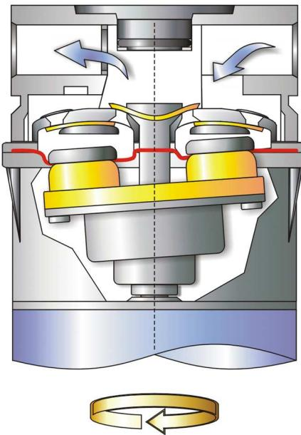
Das selbstansaugende Design ermöglicht der Pumpe einen Unterdruck zu erzeugen. Flüssigkeit wird in die Pumpe gesaugt, ohne daß diese vorher aufgefüllt werden muß.
