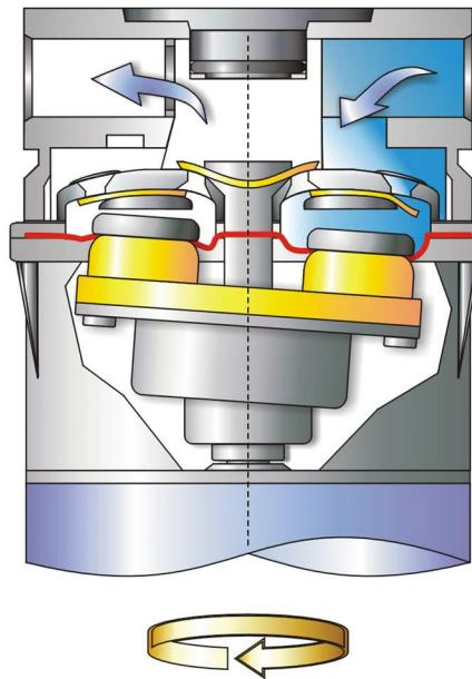
Die Flüssigkeit tritt auf der Saugseite ein und wird durch das Einlaßventil gesaugt, wenn der Kolben sich von diesem Ventil entfernt.
