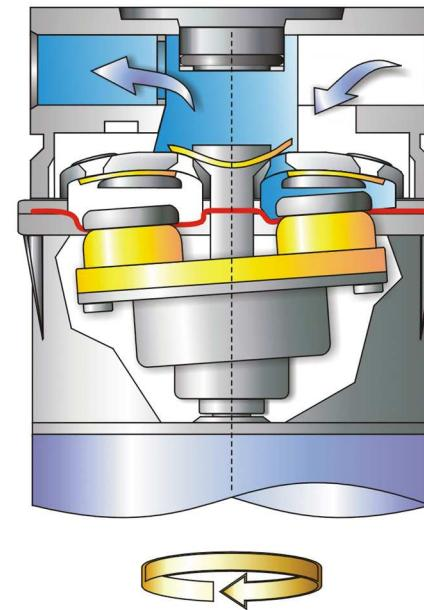
Wenn der Kolben sich nun wieder dem Einlaßventil nähert, wird die Flüssigkeit durch das Auslaßventil der Ventilkammer in den Druckstutzen der Pumpe gedrückt.
